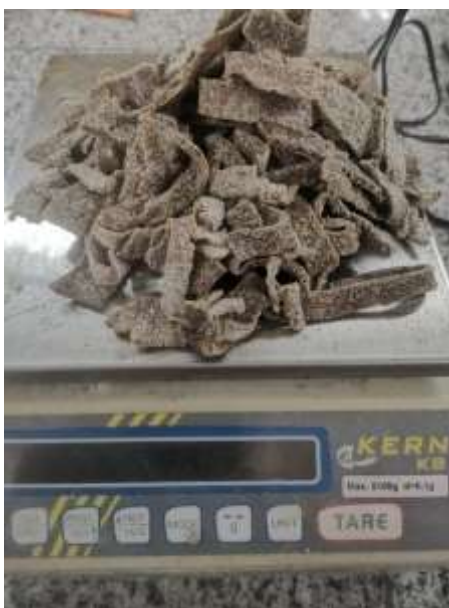
Figura 30. Pesado de la muestra de fideo para realizar el análisis de capacidad de absorción y retención del agua. Averos, 2024
