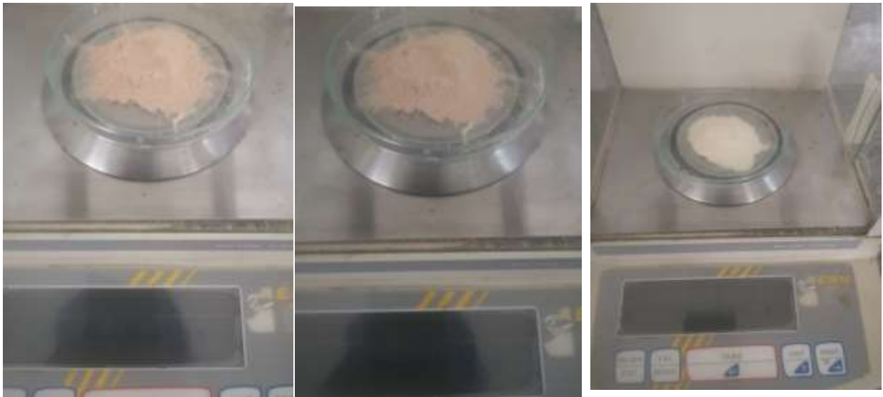
Figura 39. Pesado de los agares para realizar medios de cultivos. Averos, 2024
