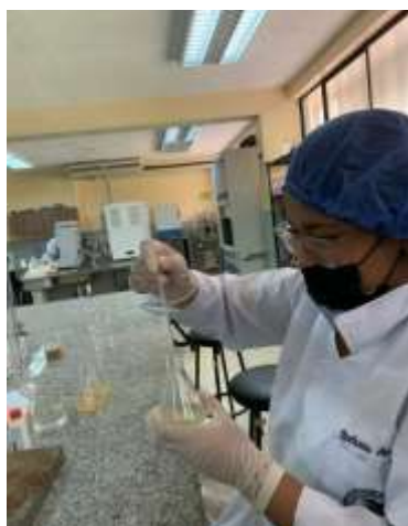
Figura 27. Adición de fenolftaleína a la muestra del macerado. Averos, 2024
