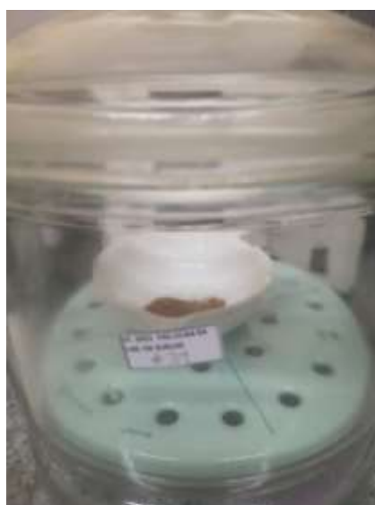
Figura 24. Capsula con fettuccini reposando en un desecador para su posterior pesado y observar la pérdida de humedad de la muestra. Averos, 2024
