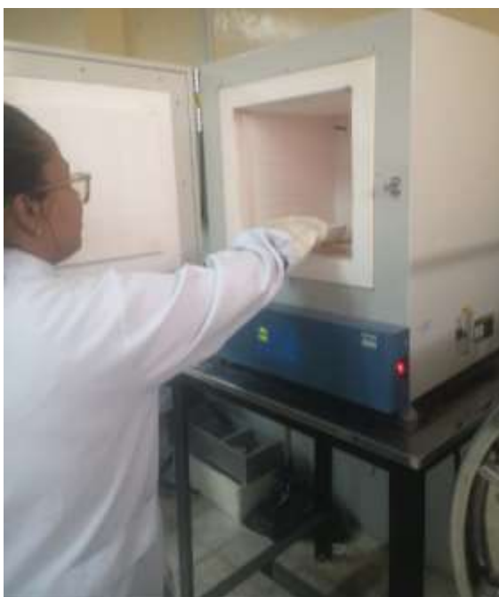
Figura 21. Colocación de la muestra en el horno para su calcinación Averos, 2024
